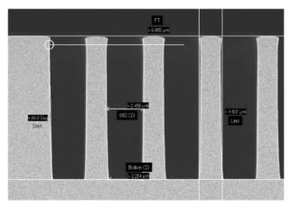
Fig. 5. 5:1 Aspect Ratio, 2µm RDL
